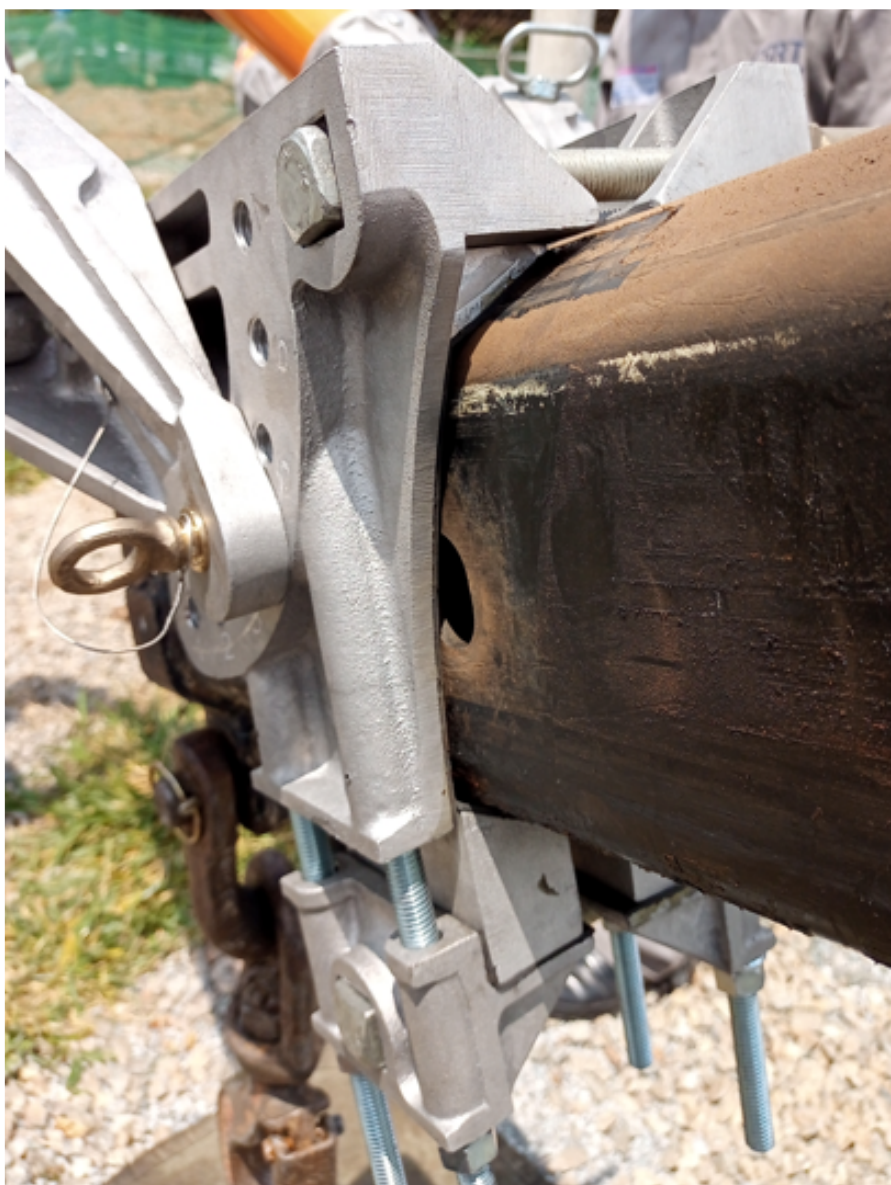
Figura 7 - Suporte instalado em braço/lança sextavado utilizando calços de apoio.
