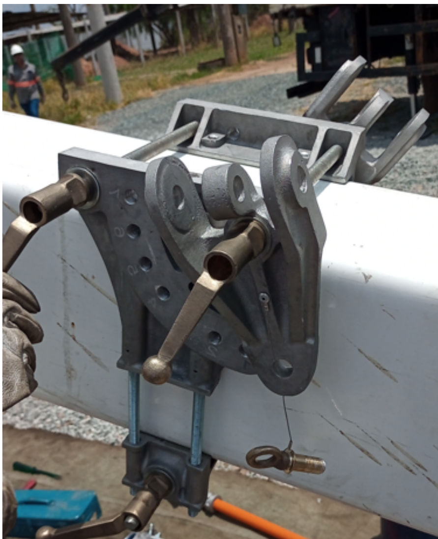
Figura 8 - Suporte instalado em braço/lança quadrado sem a utilização de calços de apoio.
